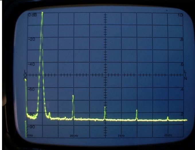
**DHT à 100 Hz – 100 Hz / Div**
