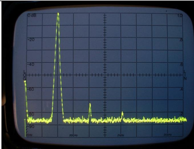
**DHT à 10 kHz – 5 kHz / Div**
