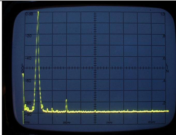
**DHT à 1 kHz - 1 kHz / Div**
